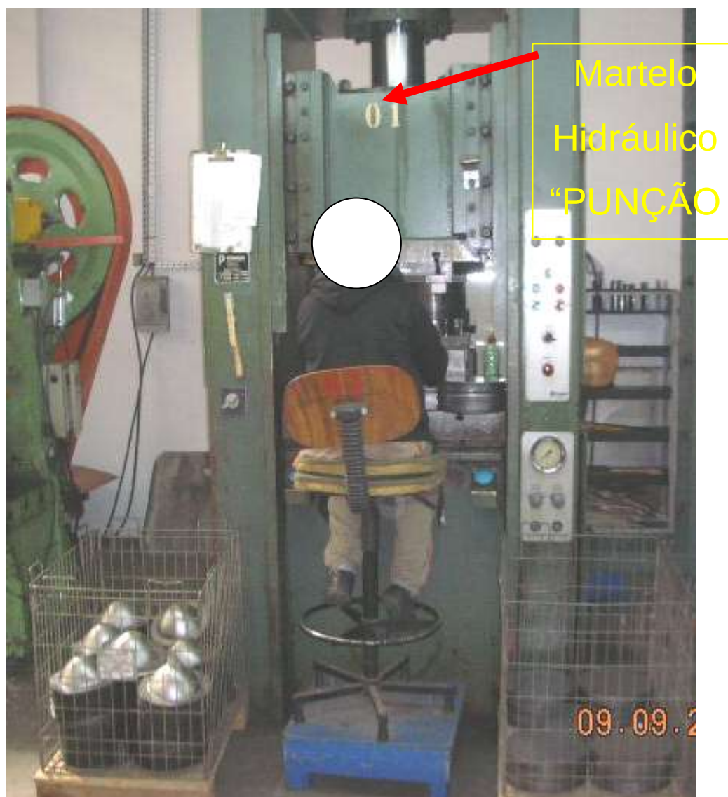
Figura 4 – Prensa hidráulica capacidade de 100ton Fonte: Arquivo pessoal (adaptada)
